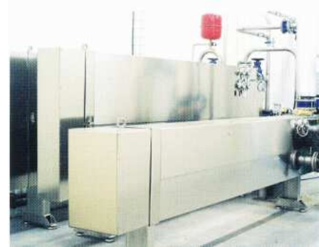
Een Läckeby slib/water warmtewisselaar en slib/slib warmtewisselaar unit in Ämhult, Zweden.
